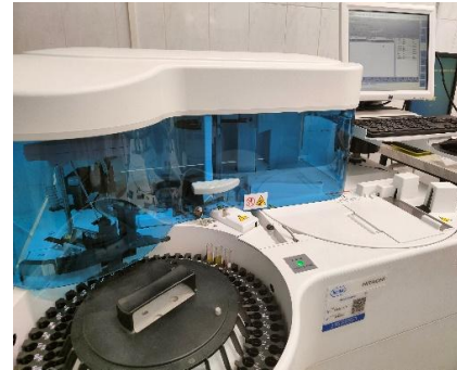
Установка пробы на борт анализатора, считывание штрих-кода, получение задания из системы
